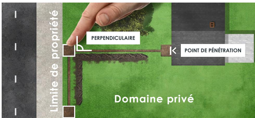
Un puits de **1 m x 1 m** en surface et de **1,2 m** de profondeur doit également être réalisé à l'endroit où le branchement va entrer dans le bâtiment pour permettre la manipulation des câbles et/ou conduites par nos techniciens.
