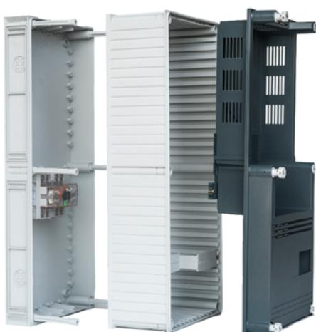
Le coffret standard à utiliser pour ce type de compteur s'appelle le « coffret 25D60 », en référence à ses dimensions de 25cm de large sur 60cm de haut. Vous pourrez vous le procurer facilement chez un revendeur de matériel électrique. Il est composé d'un fond et d'un cadre intermédiaire gris clair ainsi que d'un couvercle gris foncé ou transparent.
