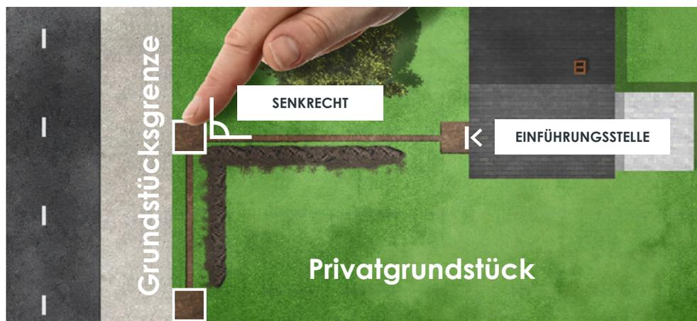
Ein Schacht von **1 m x 1 m** an der Oberfläche und **1,2 m** Tiefe ist außerdem an der Stelle auszugraben, wo der Anschluss ins Gebäude eingeführt wird, damit unsere Techniker die Kabel und/oder Leitungen einfach handhaben können.
