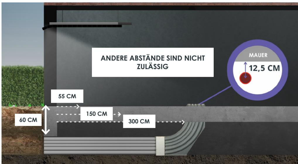
Die Zuordnung eines jeden Leerrohres ist darauf markiert. So **muss das VOO-Telekommunikationskabel im mittleren Leerrohr, d. h. dem dritten von oben, verlegt werden**. Die Rohrenden sind bei der Beschaffung mit abnehmbaren Stöpseln versehen. Lassen Sie diese bis zum Tag des Anschlusses stecken.
