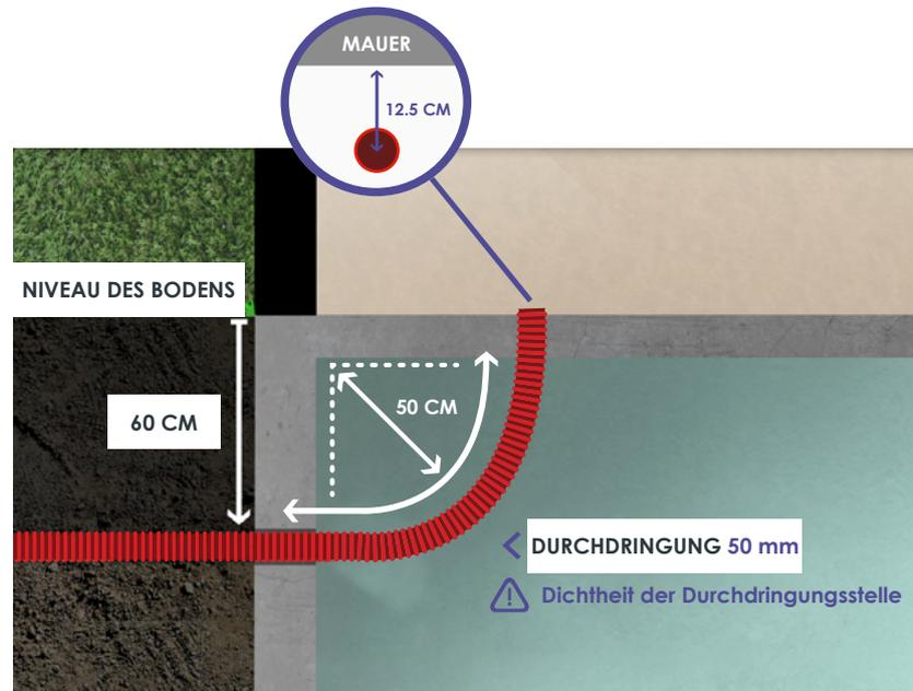
Falls der Innenanschlusspunkt sich im Untergeschoss befindet, erfolgt der Fassadendurchbruch horizontal in Richtung der Stelle, wo das zukünftige Gehäuse angebracht werden soll, mit einer leichten Neigung nach außen, um Einsickerungen zu vermeiden.
