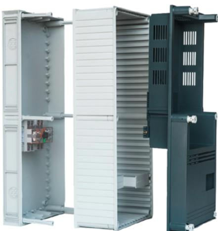
Der Standardkasten, der für diesen Zähltyp zu benutzen ist, wird „25D60-Kasten“ genannt, in Bezug auf seine Abmessungen: Breite 25 cm und Höhe 60 cm. Diesen Kasten können Sie sich ganz einfach bei einem Verkäufer von Elektromaterial besorgen. Er besteht aus einer hellgrauen Rückwand und einem hellgrauen Zwischenrahmen sowie einem dunkelgrauen oder durchsichtigen Deckel.
